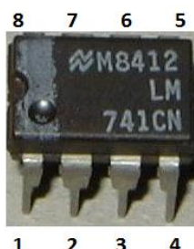
Σχήμα 2. Διάταξη ακροδεκτών τελεστικού ενισχυτή LM741.
