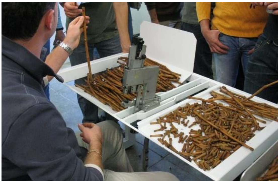
Μηχανή επιτραπέζιου εμβολιασμού. Στη μηχανή τοποθετούνται κληματίδες και από το υποκείμενο και από το εμβόλιο. Η μηχανή κάνει δύο τομές (αρσενικό-θηλυκό), έτσι ώστε η μια (κληματίδα) να θηλυκώνει μέσα στην άλλη.
