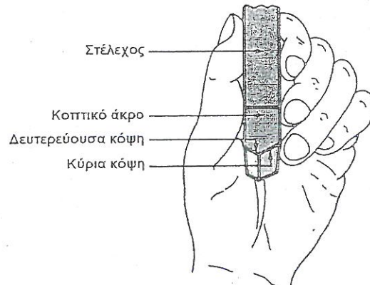
Σχήμα 1 Καθορισμός δεξιού ή αριστερού εργαλείου.
