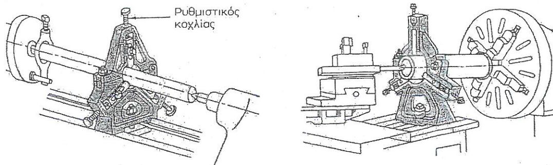
Σχήμα 1.4ια : Σταθερό καβαλέτο. Συγκράτηση μεταξύ κέντρων και πλατώ που φέρει σφιγκτήρες.
