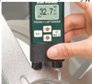
Εικόνα 10: Η συσκευή υπερήχων και δινορευμάτων για μέτρηση πάχους επικαλύψεων
