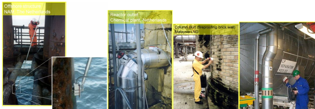
Εικόνα 4: Έλεγχος ρωγμών με τη συσκευή δινορευμάτων στην πράξη
