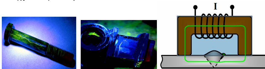
Εικόνα 3: Έλεγχος με Μαγνητικά Ρινίδια σε διάφορα μηχανολογικά εξαρτήματα. Τα δοκίμια ελέγχονται σε ειδικό φως που αναδεικνύει καλύτερα τις ατέλειες.
