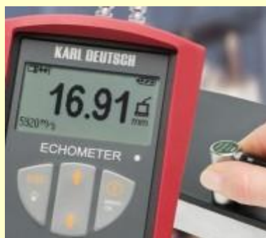
Εικόνα 9. Ηλεκτρονικής Συσκευής Μέτρησης (με Υπερήχους) Πάχους Επικαλύψεων ECHOMETER 1076TC της Karl Deutch
