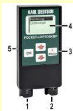
Εικόνα 8. Ηλεκτρονικής Συσκευής Μέτρησης (με Δινορρεύματα) Πάχους Επικαλύψεων μοντέλο LEPTOSKOP 2026της Karl Deutch
