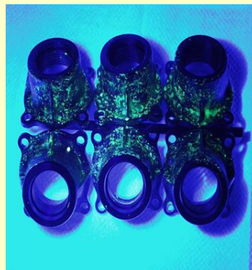
Εικόνα 4. Οι ενδείξεις των ασυνεχειών γίνονται λιγότερο διακριτές καθώς αυξάνει το επίπεδο “θορύβου”.
