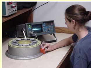
Εικόνα 11. Εφαρμογές ελέγχου με τη μέθοδο των δινορρευμάτων στα αεροσκάφη (Rao 2013).
