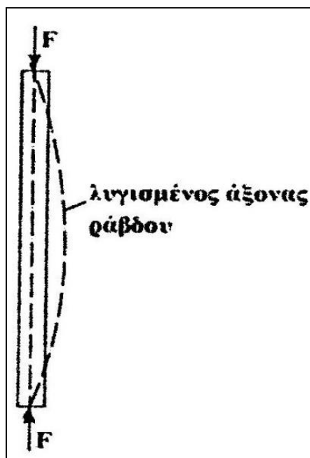
Σχήμα 3-11. Καταπόνηση σε λυγισμό.
