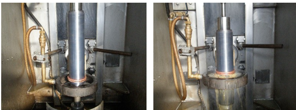
Σχήμα 11.10: Στιγμιότυπο από την επαγωγική βαφή πείρου. Το πηνίο ακολουθείται από καταιωστήρα ψυκτικού υγρού.
