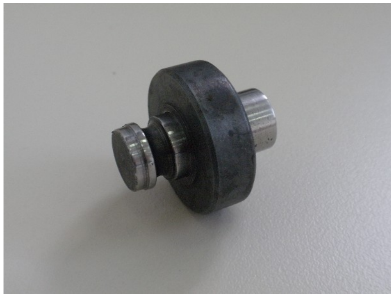
Σχήμα 11.15: Επιφανειακή σκλήρυνση πείρου και δακτυλίου με ενανθράκωση (61.0 HRC και 55.0 HRC αντίστοιχα).
