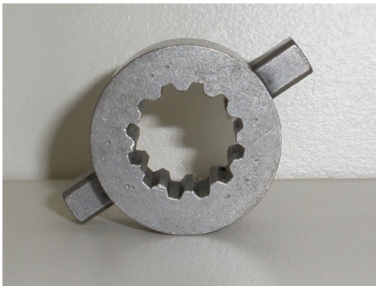
Σχήμα 11.16: Επιφανειακή σκλήρυνση κόμπλερ αντλίας με ενανθρακαζώτωση (min 40 HRC, βάθος βαφής 0.25 mm – 0.65 mm).
