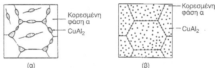
Σχήμα 11.25: Κρυσταλλική δομή του κράματος Al-Cu (4% κ.β. Cu). (α) Μετά από αργή απόψυξη από τους 550°C, (β) Μετά από κατακρήμνιση μέσω γήρανσης.
