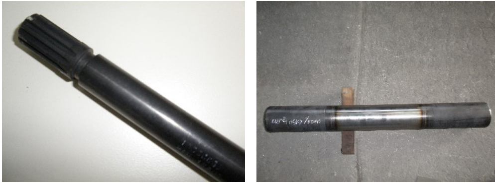
Σχήμα 11.11: (α) Σκλήρυνση σε καρέ οδηγού άξονα ανεμιστήρα οχήματος (32-38 HRC, βάθος βαφής 0.5mm), (β) σκλήρυνση των δυο άκρων πείρου με επαγωγική βαφή.
