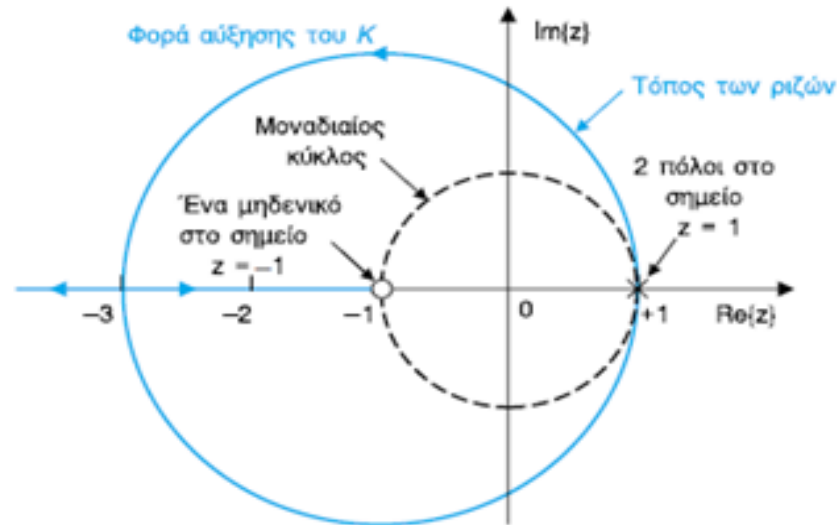
Σχήμα Διάγραμμα τόπου ριζών για το σύστημα Παραδείγματος με D(z)=1
